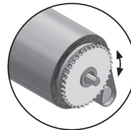
Zur Montage und Demontage des Rollos transparentes Kunststoffrad drehen.
